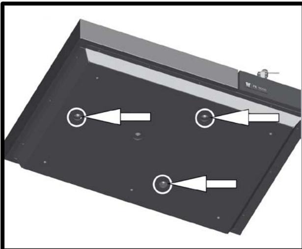
F 6 - Einstellung Laufwerk Subchassis
