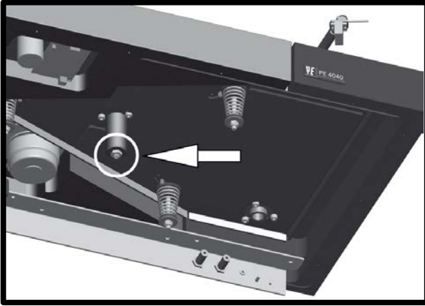
F 5 - Einstellung Laufwerk Plattentellerlager
